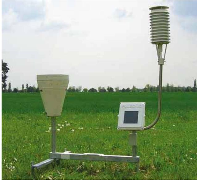
Les stations qui équiperont le réseau METEO à l'Ecole permettent la mesure automatisée de deux paramètres : température et précipitations.
