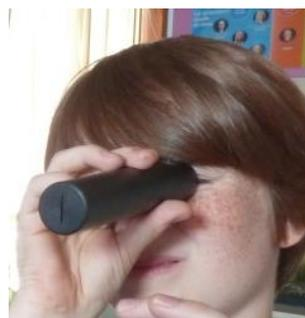
**Remarque :** afin de comprendre que les spectroscopes utilisés sont simplement constitués d'une fente (que l'on voit de l'extérieur) et d'un réseau, il est possible d'utiliser un réseau pour observer directement les lumières de la classe. Pour mémoire, un réseau est constitué d'un très grand nombre de traits très fins et très serrés, souvent entre 200 et 600 traits par millimètre.
